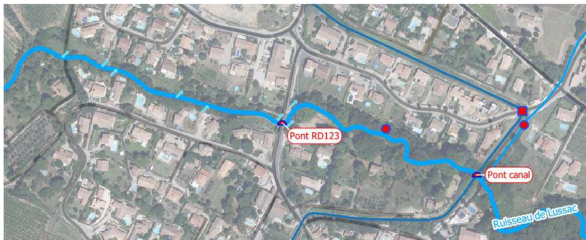
Figure 132 : Localisation des points de rejet pluvial dans le ruisseau de Lussac (flèche bleu ciel)
