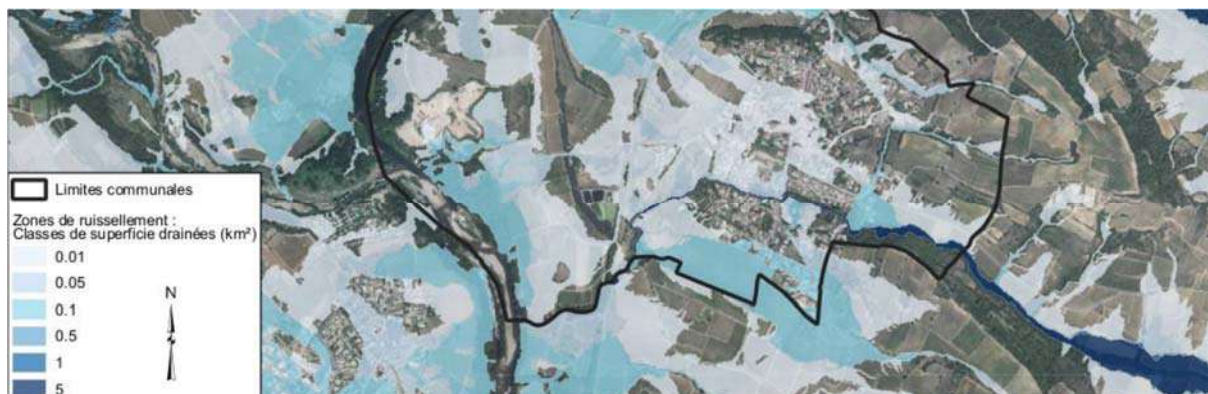
Figure 45 : Extraction des zones d'écoulement (EXZECO)
