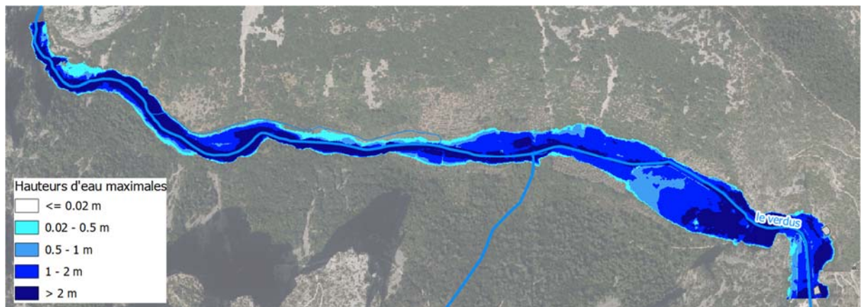
Figure 14 : Hauteurs d'eau maximales – Crue 100 ans – Situation actuelle
