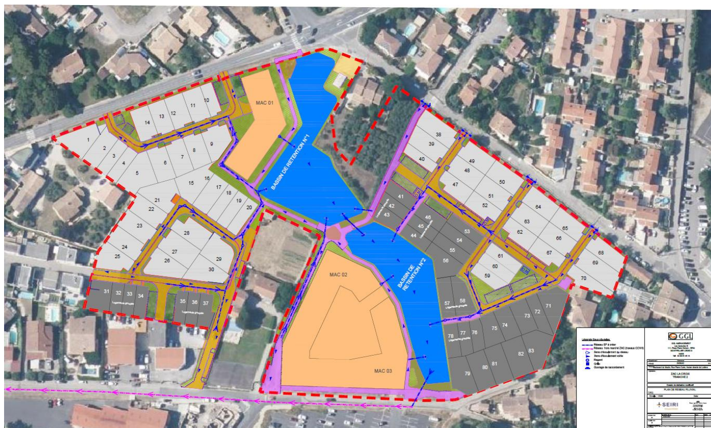
Plan du réseau pluvial
