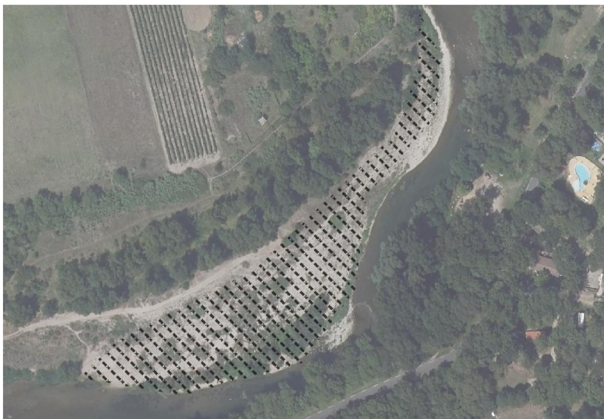
Figure 12 : Exemple d'orientation des sillons de ripage préconisée pour la seconde passe
