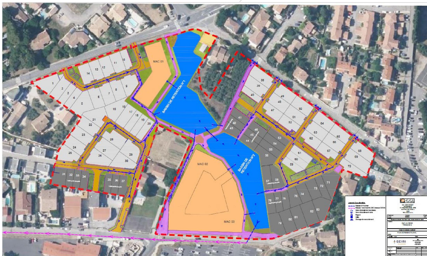
Figure 149 : Plan du réseau pluvial - SEIRI
