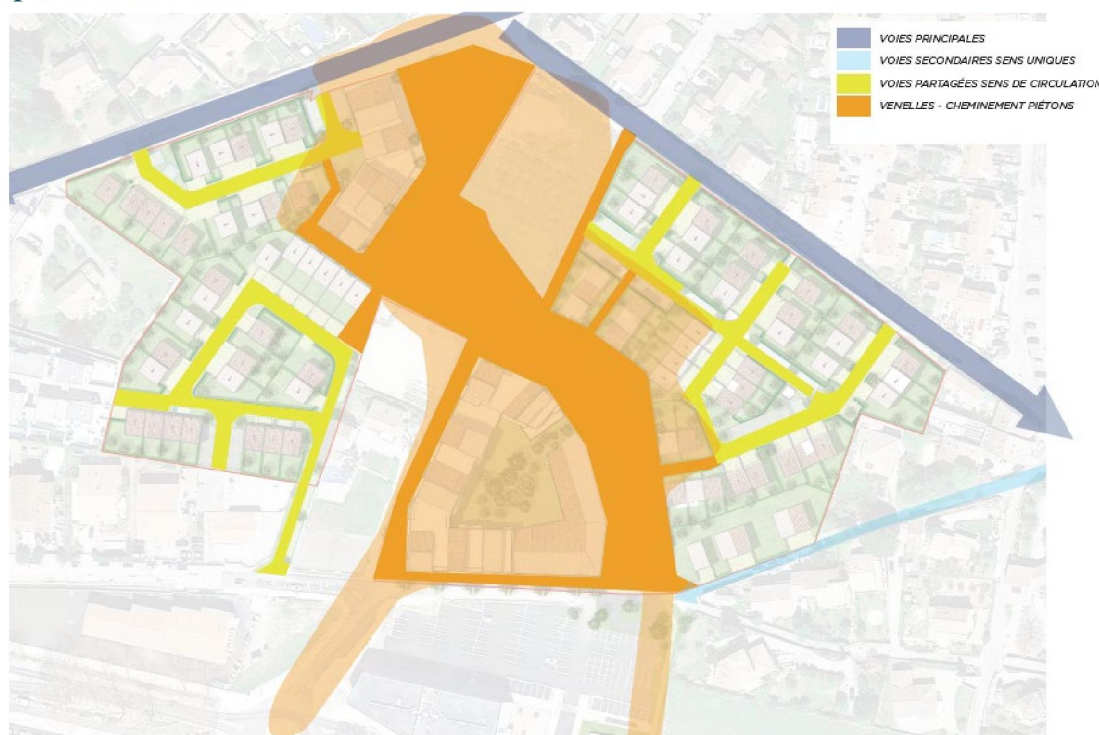
Figure 12 : schéma d'intention des axes structurants encadrant le quartier d'habitat et cheminements doux
